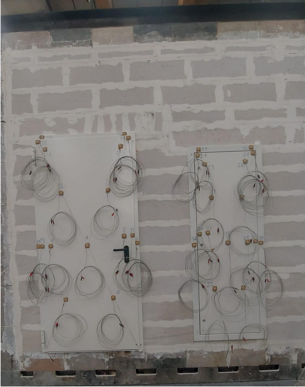
Fotoğraf C1: Test numunelerinin aleve maruz kalmayan yüzeylerinin test öncesi görünümü
